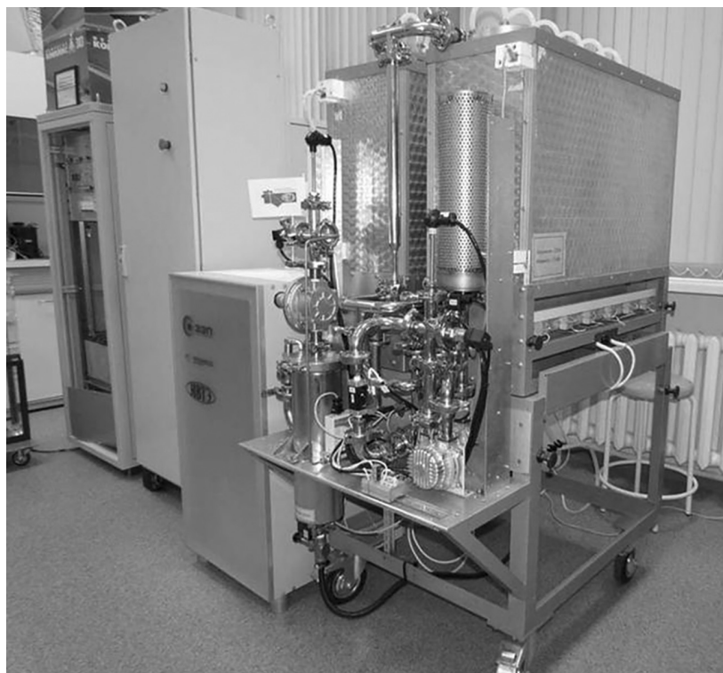
Автономный источник тока мощностью 1,5 кВт (АИТ-ТОТЭ-1500), в создании которого принимали активное участие сотрудники лаборатории электрохимических устройств на твердооксидных протонных электролитах.
